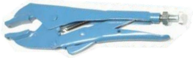
Durch die beiden Spitzen in den Greifbacken der Zange lassen sich Reparaturbleche am Fahrzeug einfach und millimetergenau justieren
