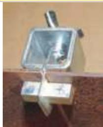
Zum arretieren und halten von Blech- und Karosserieteilen, die stumpf geschweißt werden.
