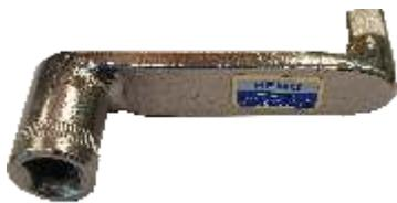
Zur Betätigung schwer zugänglicher Muttern durch Versetzen der Angriffssache des Schlüssels
