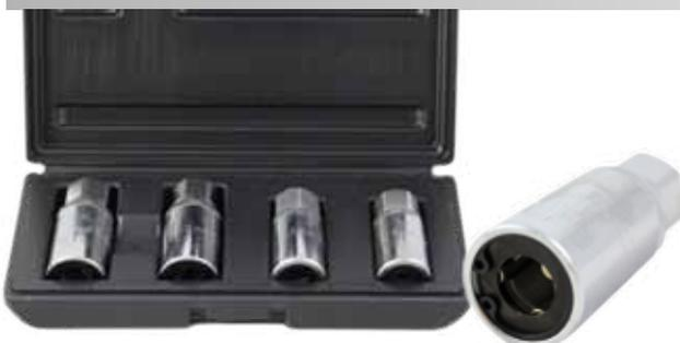
Geeignet zum entfernen von Stehbolzen/Stockschrauben (z. B. im Zylinderblock). Einfach das Werkzeug auf dem Stehbolzen platzieren und mit einer 1/2" - Ratsche lösen. Die Kraftübertragung erfolgt über 3 innenliegende Wellen, die den Bolzen festklemmen.
